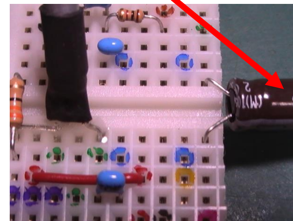
6) 電解コンデンサ (リードが90度曲がってる)
