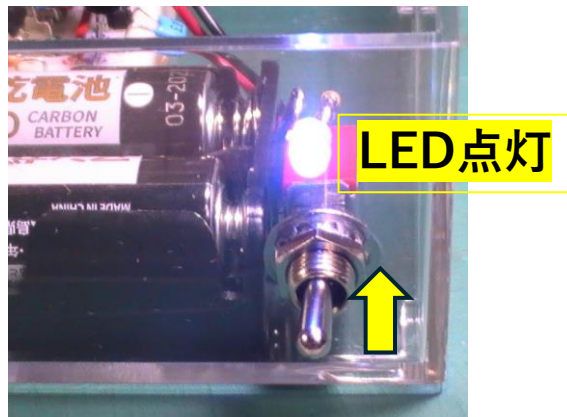
2) 電源スイッチON(上に倒す)
