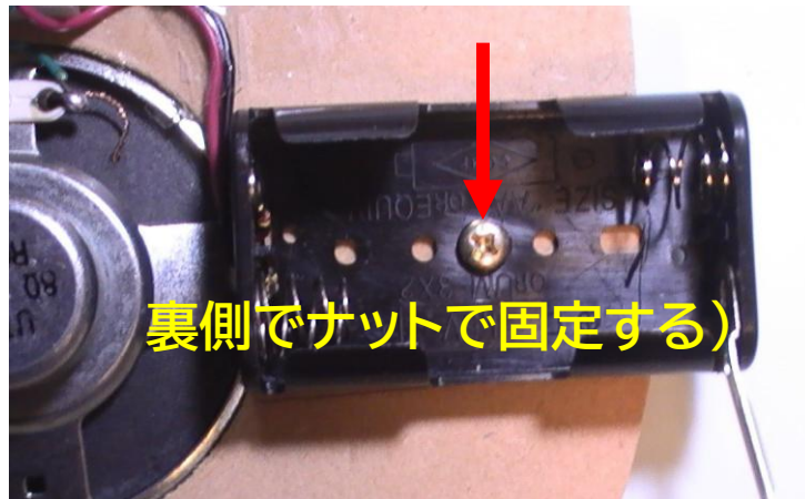
④電池BOX固定
